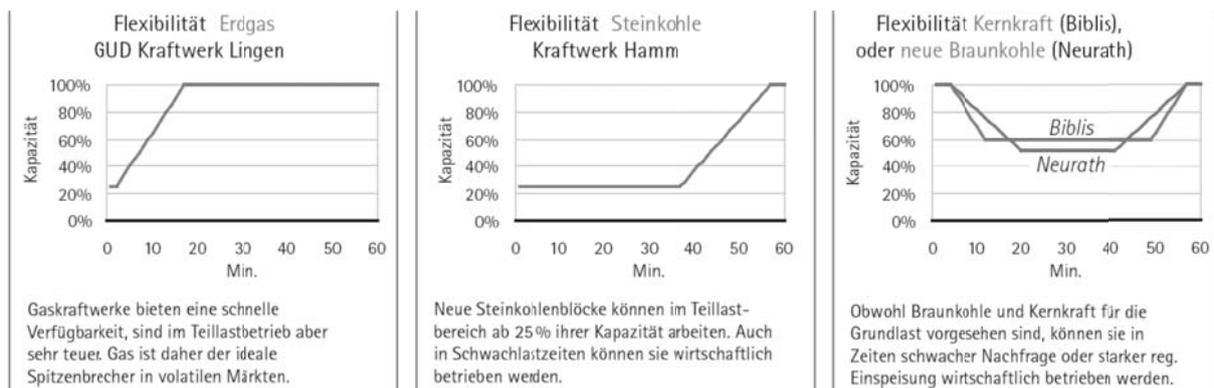
**Abbildung 46: Verfügbarkeit von Kraftwerken [VGB]**
